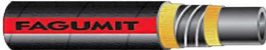
*Напорно-всасывающий шланг для транспортировки растворов: азотной кислоты концентр. до 20 %, серной кислоты концентр. до 80 %, соляной кислоты концентр. до 36 %, растворов гидроокиси натрия, уксусной кислоты и аммиака с любой концентрацией, воды и множества лёгких химикалий*
